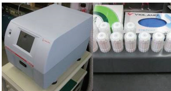
図1 マイクロ波試料前処理装置(左)と専用容器(右)。フッ素樹脂製の分解容器に試料と溶媒を入れて、マイクロ波を照射し、加熱分解させ固体試料を溶液化する。
