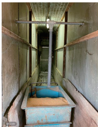
図7 応急的なドロップパイプ設置
